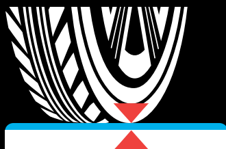
3 mm mønsterdybde 9.5 m lengre bremselengde (resthastighet: 34 km/h)*
