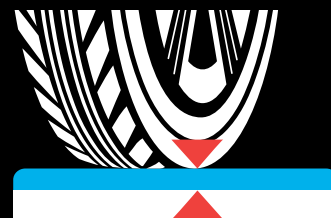
1.6 mm mønsterdybde 18.6 m lengre bremselengde (resthastighet: 44 km/h)*
